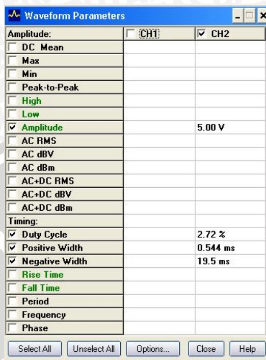
Gambar 5.5 Gambar Waveform Parameter pada Sudut 0°
