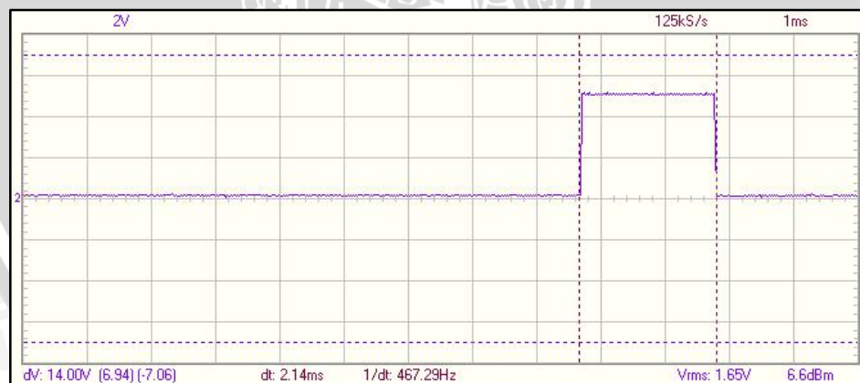
Gambar 5.16 Gambar Sinyal Kontrol Motor DC Servo pada Sudut 150°
