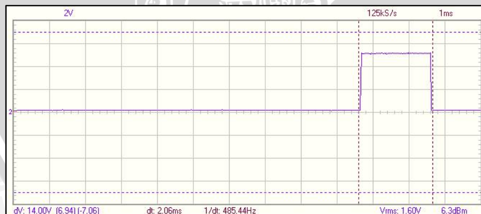
Gambar 5.14 Gambar Sinyal Kontrol Motor DC Servo pada Sudut 135°
