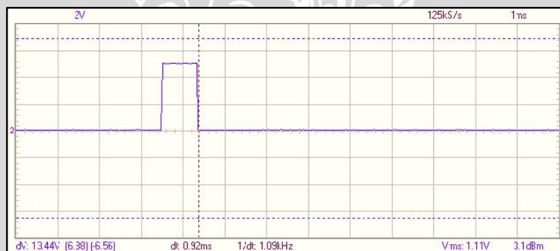
Gambar 5.6 Gambar Sinyal Kontrol Motor DC Servo pada Sudut 30°
