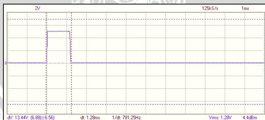
Gambar 5.10 Gambar Sinyal Kontrol Motor DC Servo pada Sudut 60°
