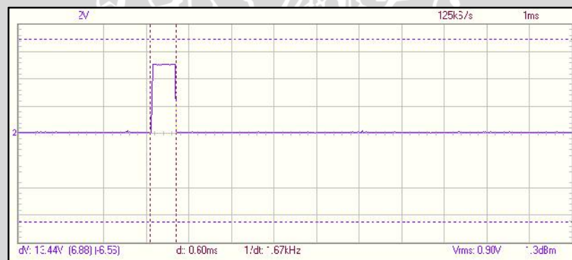
Gambar 5.4 Gambar Sinyal Kontrol Motor DC Servo pada Sudut 0°
