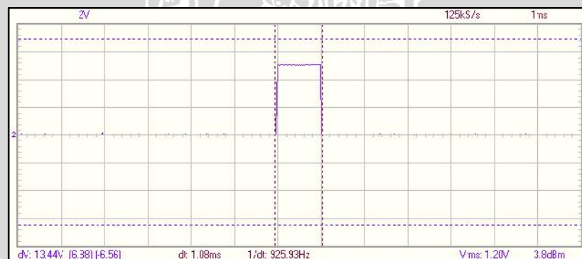
Gambar 5.8 Gambar Sinyal Kontrol Motor DC Servo pada Sudut 45°
