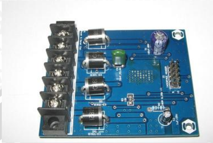
Gambar 2.4 Pengendali motor DC menggunakan EMS 5A H-Bridge Koneksi Modul EMS 5A H-Bridge
