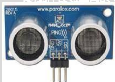
Gambar 2.3. Sensor Jarak Ultrasonik (PING))) Sumber: Parallax, 2008
