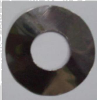
Gambar 3.4 Spesimen (*Stainless steel* tebal 0,1mm, Produksi *Taiho Trading CO.,LTD* Jepang)
