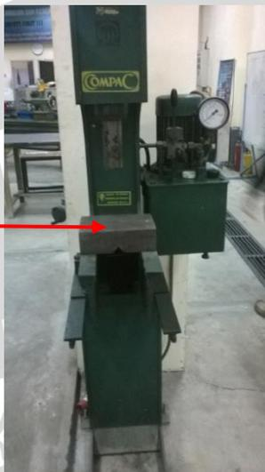
Gambar 3.6 Posisi *Table* Pada Mesin Press
