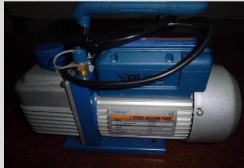
Gambar 3.9 Mesin vakum refrigeran
