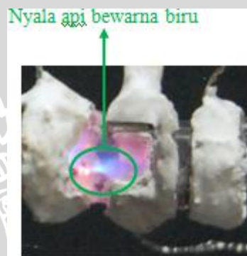
Gambar 4.15 Warna nyala api dalam meso-scale combustor dengan double fuel inlet dan triple wire mesh .
