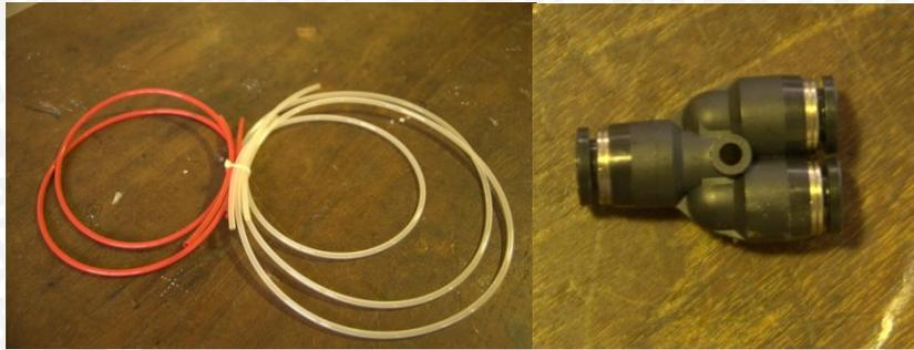
Gambar 3.14 *Pisco tube* dan *Y connector*
