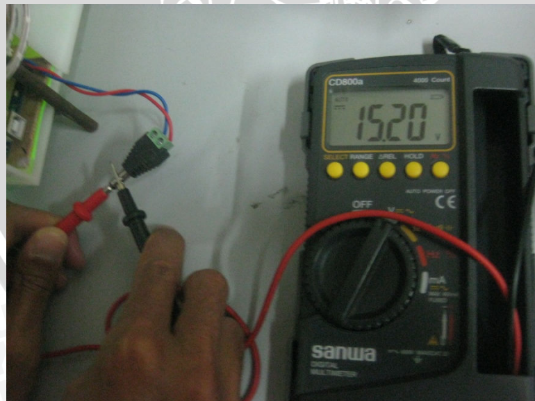
Gambar 5.3 Foto Pengujian Rangkaian Catu Daya 16,8 V 1 A Tanpa Beban
