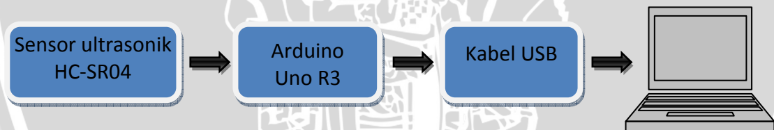
Gambar 5.14 Diagram Blok Pengujian Sensor Ultrasonik HC-SR04
