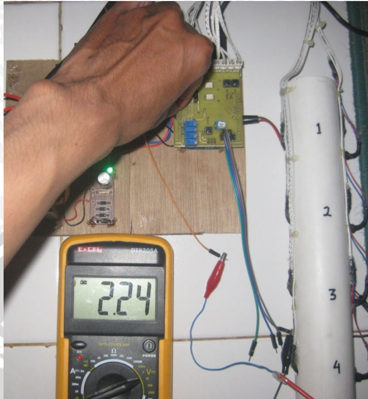
Gambar 5.12 Foto Pengujian Tegangan Keluaran Sensor Kejernihan
