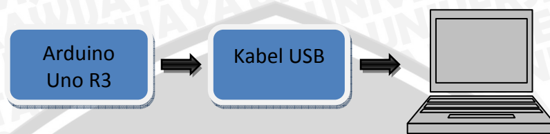
Gambar 5.7 Diagram Blok Pengujian Modul Mikrokontroller Arduino Uno R3
