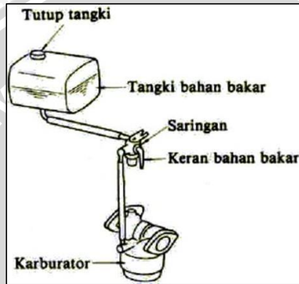
Gambar 2.1 Sistem Penyaluran Bahan Bakar pada Motor Konvensional. Sumber: Astra Honda Motor (2001)
