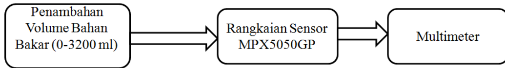
Gambar 5.2 Diagram Blok Pengujian Pertama Sensor MPX5050GP.
