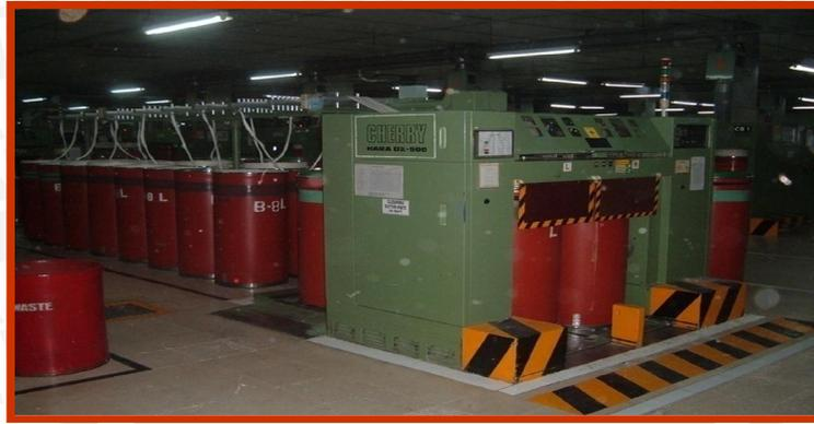
Gambar 4.8 Mesin *Drawing*
