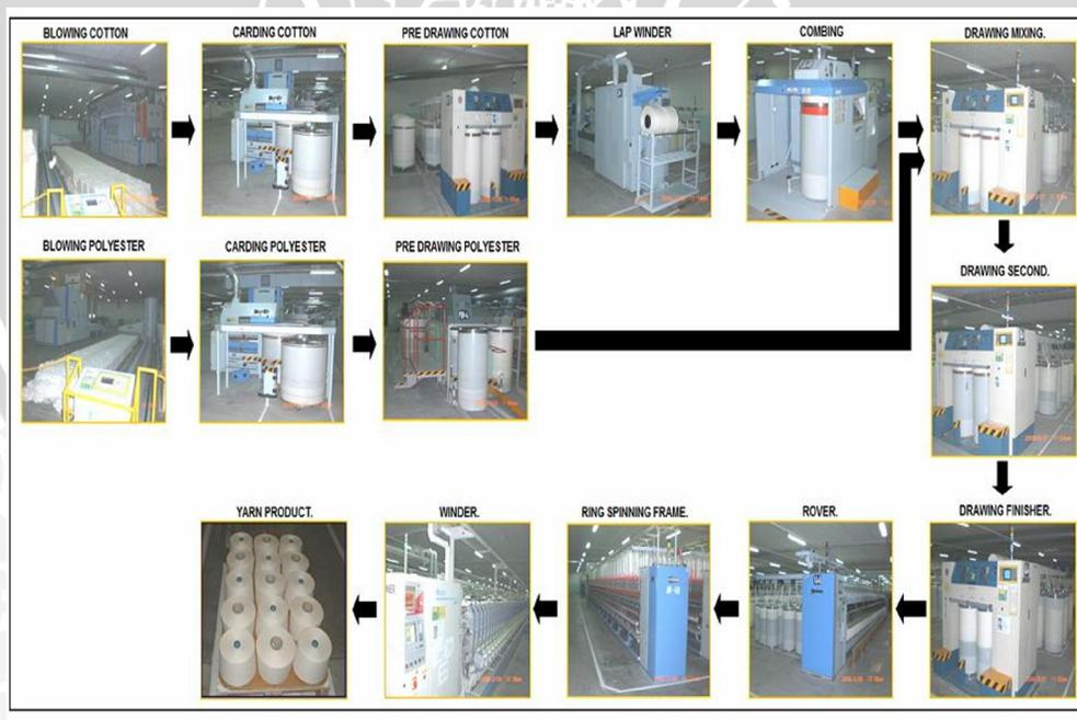
Gambar 4.3 *Flow* Proses Pembuatan benang
