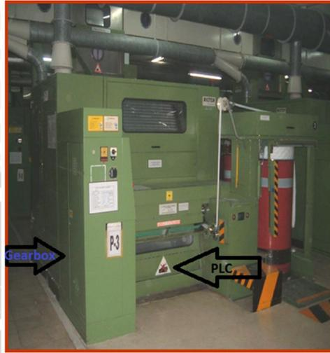
Gambar 4.14 Letak Komponen PLC dan *Gearbox* Pada Mesin *Carding Cotton*
