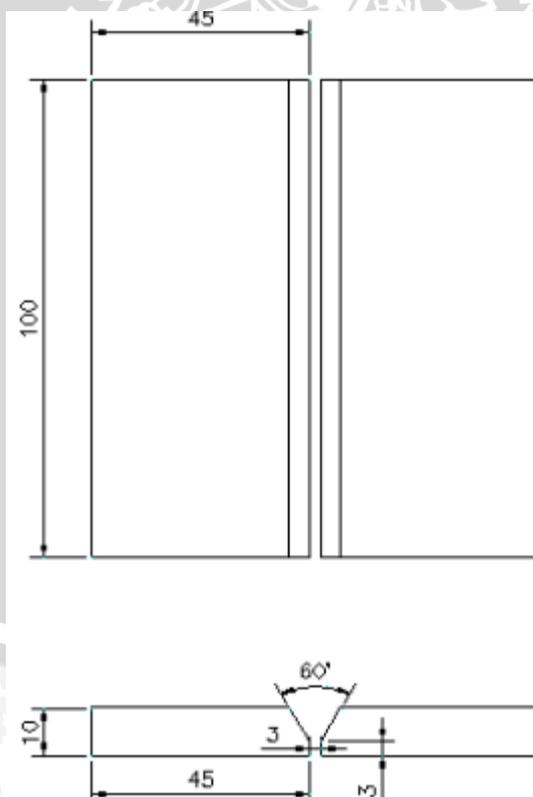
Gambar 3.6 Spesimen Pengelasan
