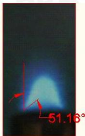
Gambar 4.1 Pengukuran sudut api ( $\theta$ )
