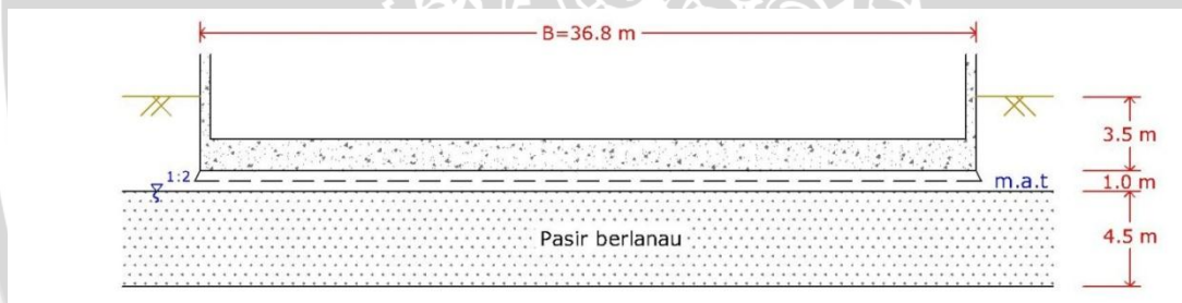
Gambar 4.41 Metode 2V:1H untuk menghitung tambahan tegangan
