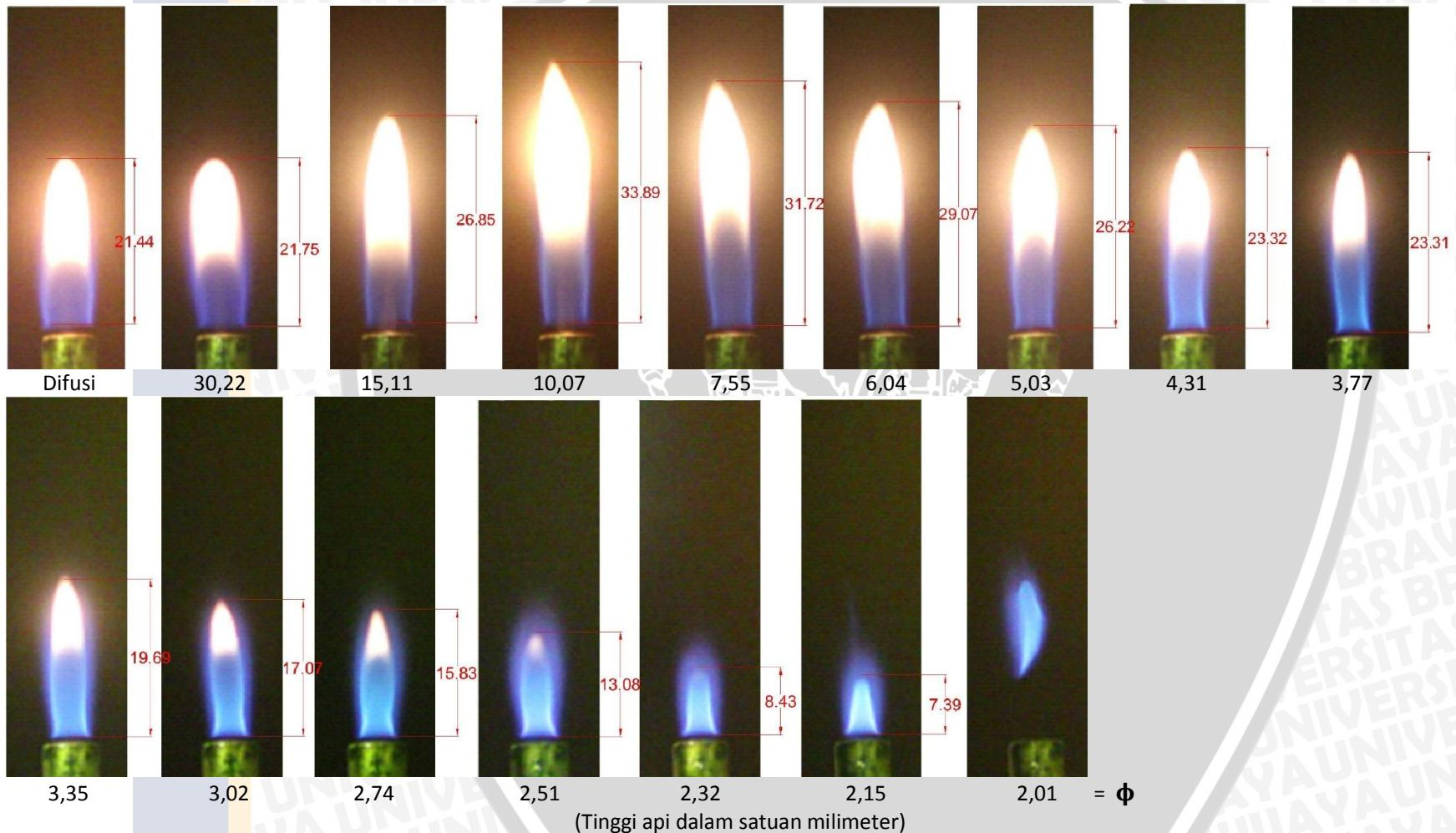
Lampiran 5. Foto sudut kerucut api pada laju penguapan 0,046 mL/min
