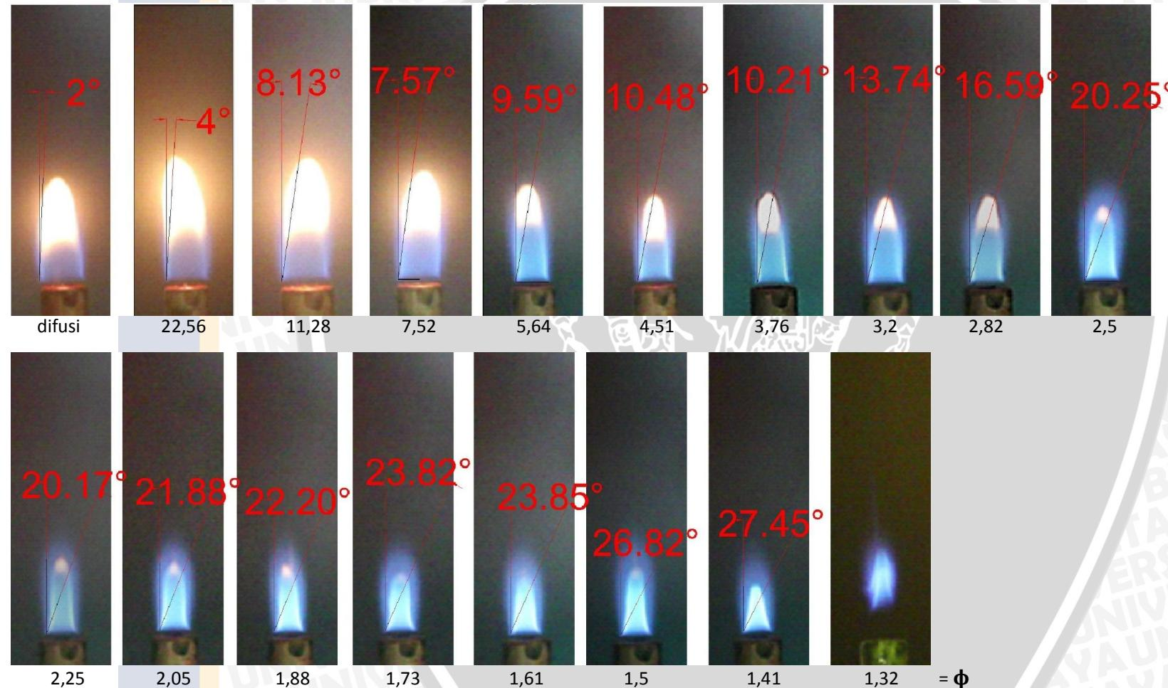
Lampiran 7. Foto sudut kerucut api pada laju penguapan 0,123 mL/min
