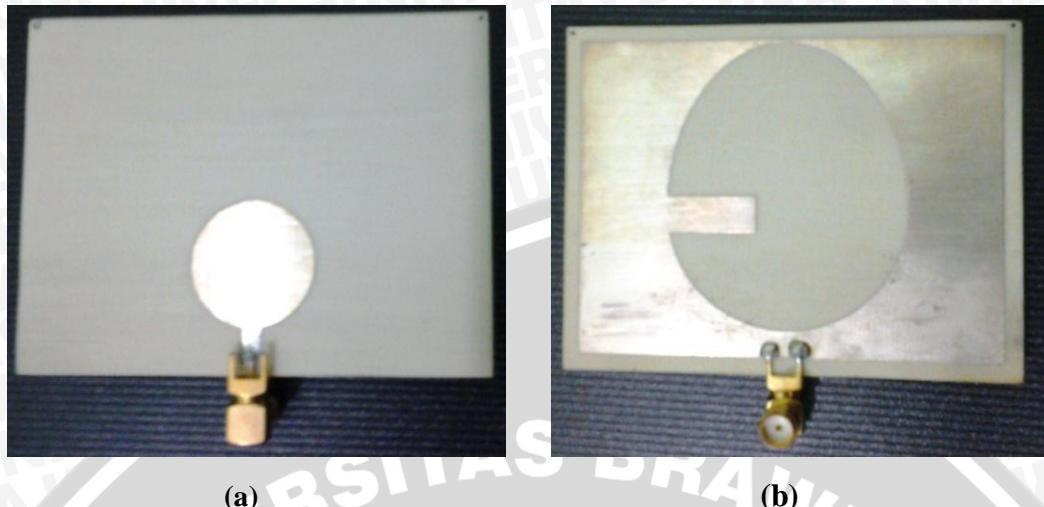
Gambar 53 Antena Fabrikasi Mikrostrip *Circular Patch* dengan Slot Egg (Konfigurasi 65)
