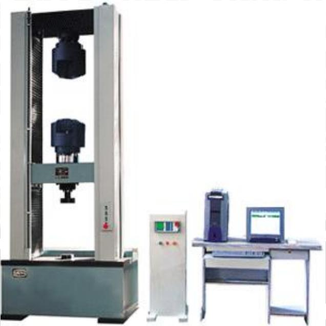
Gambar 3.3 Mesin uji tarik
