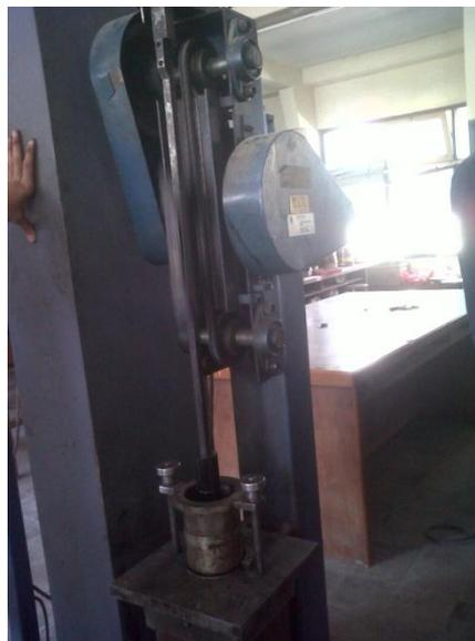
**Gambar 3. 2** Foto *Automatic Asphalt Compactor*
