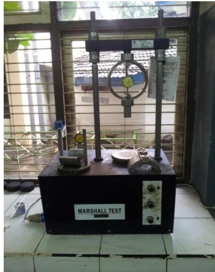
**Gambar 3. 3** Foto Alat Pengujian Marshall
