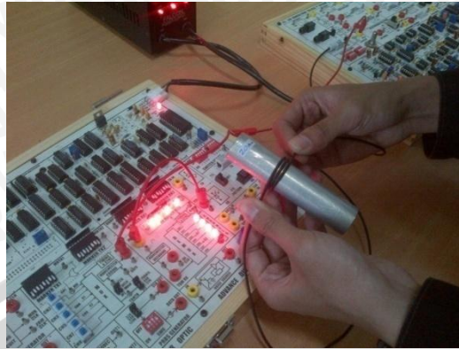
Gambar 4.17. Macrobending pada POF dengan Mandrel
