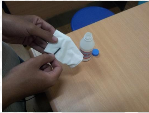
Gambar 4.9. Pembersihan POF dengan Alkohol 95%
