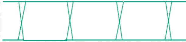
Gambar 2.20. *Eye diagram* Ideal dengan *Finite Rise* dan *Fall Time*
