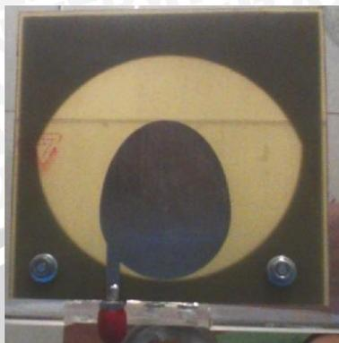
**Gambar 59.** Antena fabrikasi mikrostrip egg dengan slot *rugby ball*
