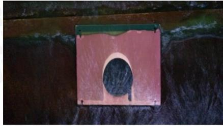
**Gambar 56.** Proses melarutkan tembaga pada FR4 menggunakan *Ferric Chloride* ( $\text{FeCl}_3$ )
