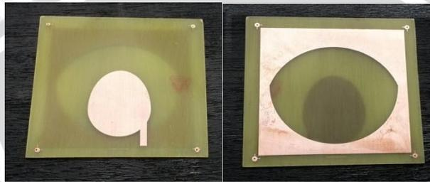
**Gambar 57.** Antena mikrostrip *egg* dengan slot *rugby ball*
