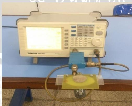
**Gambar 66.** Rangkaian pengukuran antena
