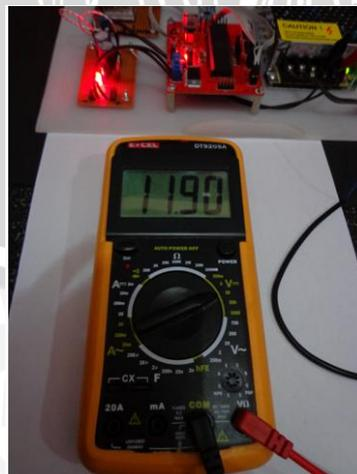
**Gambar 5.6** Hasil Pengujian Catu Daya 12 V 5 A Berbeban
