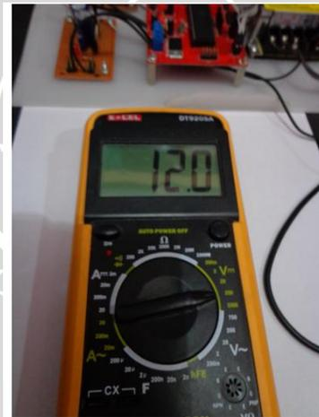
**Gambar 5.5** Hasil Pengujian Catu Daya 12 V 5 A Tanpa Beban
