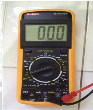
**Gambar 5.11.** Hasil Pengujian Driver Relay HRS4H-S-DC12V Tanpa Pemicu
