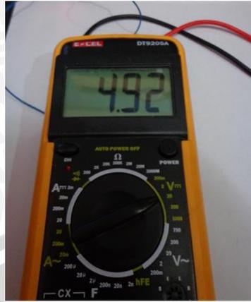
**Gambar 5.14** Hasil Pengujian Limit Switch Saat Tidak Aktif
