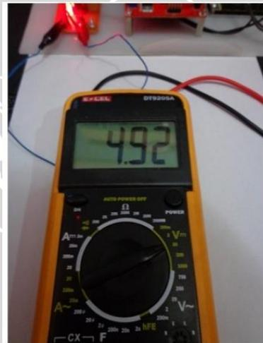
**Gambar 5.7** Hasil Pengujian Catu Daya 5 V Tanpa Beban
