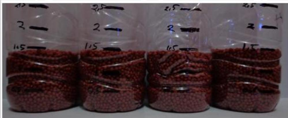
**Gambar 5.17** Hasil Keluaran Pellet Dari Masing – masing Pipa Keluaran Dengan Takaran 150 gr
