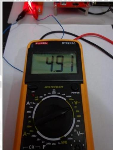
**Gambar 5.8** Hasil Pengujian Catu Daya 5 V Berbeban
