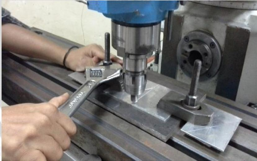
Proses pengencangan spesimen sebelum proses pengelasan
