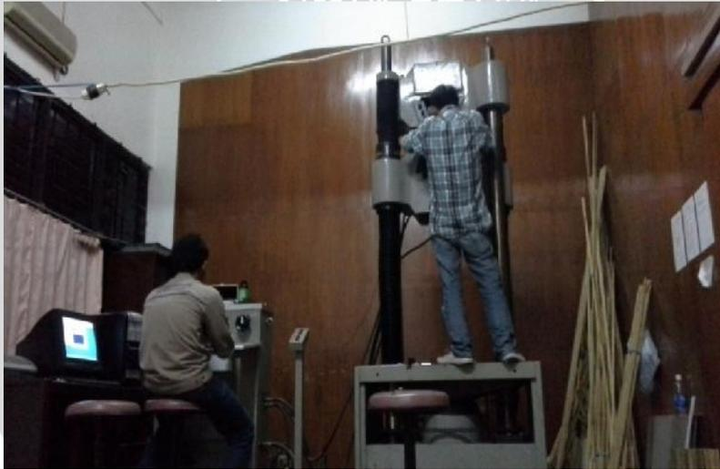
Proses pemasangan benda kerja untuk uji tarik
