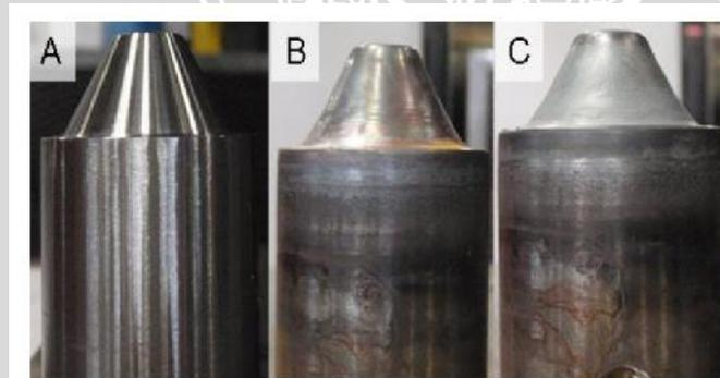
Gambar 2.8 Bentuk pin tirus sebelum dan sesudah digunakan pada *Friction Stir Welding*
