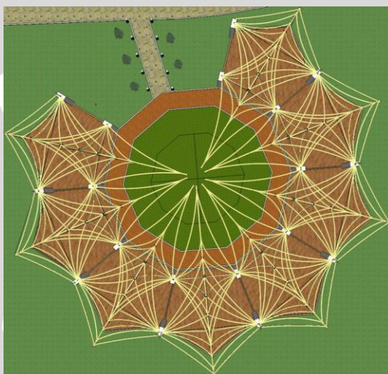
Gambar 4.64 Tampak atas rangka atap ruang kelas
