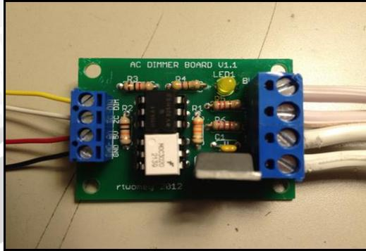
Gambar 2.8 AC Dimmer Module Lite (v1.1)
