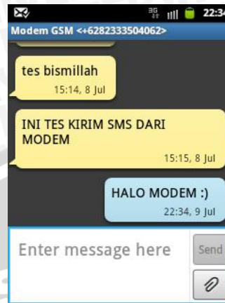
Gambar 5.18. Tampilan SMS yang Dikirimkan oleh Handphone kepada Modem GSM untuk Diteruskan ke Mikrokontroler
