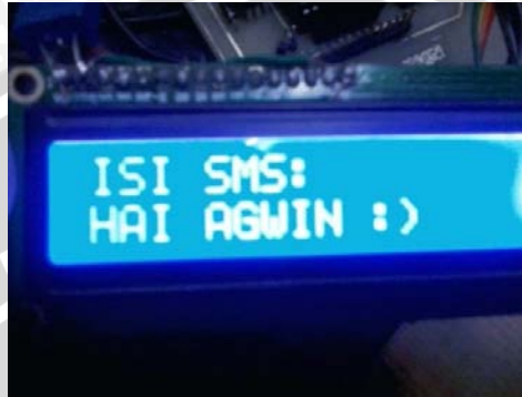
Gambar 5.16. Isi Pesan SMS yang Dikirimkan oleh Mikrokontroler kepada Modem GSM untuk Diteruskan ke Perangkat Handphone
