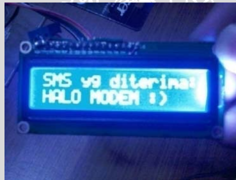
Gambar 5.19. Tampilan Pesan SMS yang Diterima Mikrokontroler
