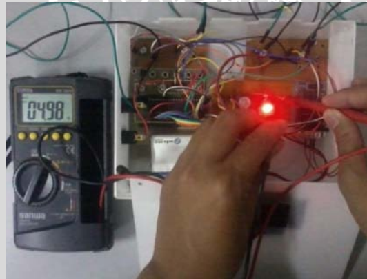
Gambar 5.2. Hasil Pengujian Rangkaian pada Saat Keadaan Tanpa Beban
