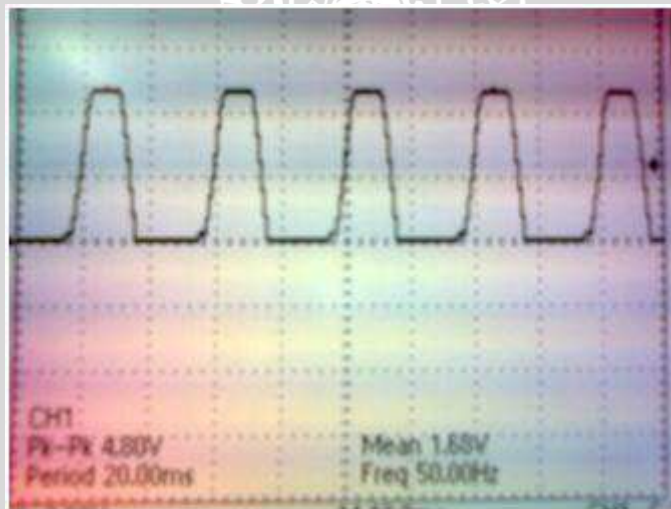
Gambar 5.7 Bentuk keluaran sensor saat frekuensi 50 Hz
