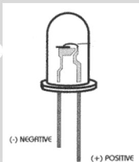
Gambar 2.13 Bentuk Fisik LED
