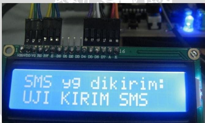
Gambar 5.19 Isi Pesan SMS yang Dikirimkan oleh Mikrokontroler kepada Modem GSM untuk Diteruskan ke Perangkat *Handphone*
