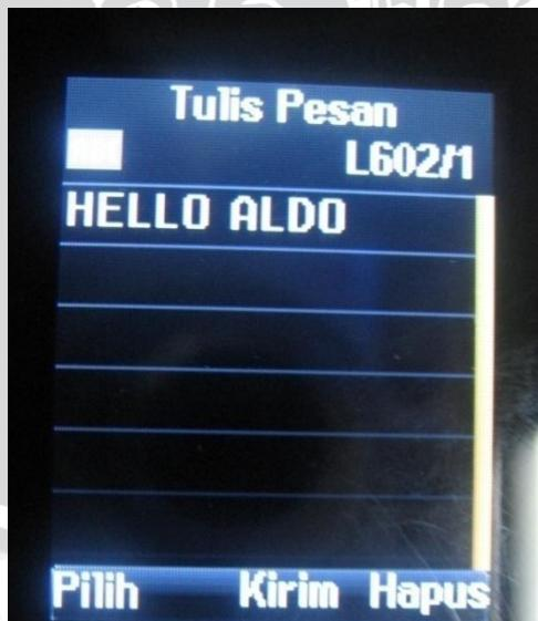
Gambar 5.21 Tampilan SMS yang Dikirimkan oleh *Handphone* kepada Modem GSM untuk Diteruskan ke Mikrokontroler
