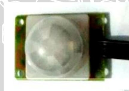
Gambar 2.6 Bentuk Fisik Sensor *Passive Infrared Receiver*
