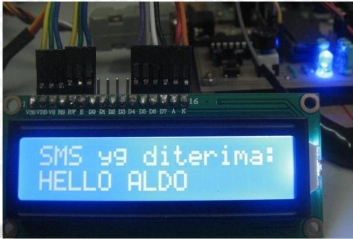
Gambar 5.22 Tampilan Pesan SMS yang Diterima Mikrokontroler
