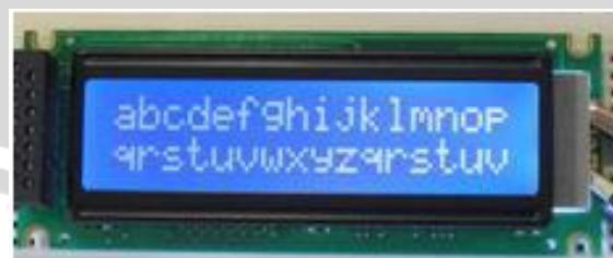
Gambar 2.12 Bentuk Fisik Modul LCD 16x2 Karakter
