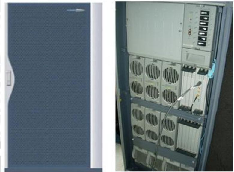
Gambar 2.2 Bentuk Fisik Perangkat BTS
