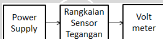
Gambar 5.12. Diagram blok pengujian rangkaian sensor tegangan solar cell dan accu 1
