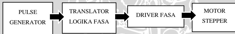
Gambar 5.1 Diagram Blok Pengujian Kecepatan Motor *Stepper*.
