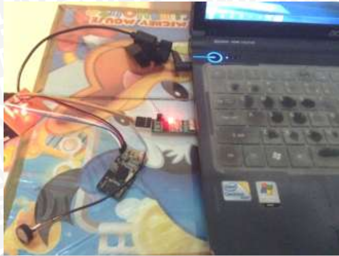
Gambar 4.11 Proses Penyamplingan suara menggunakan EasyVR
