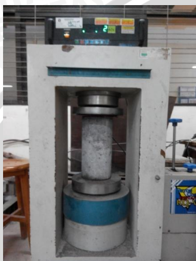
Gambar Proses Uji Tekan
