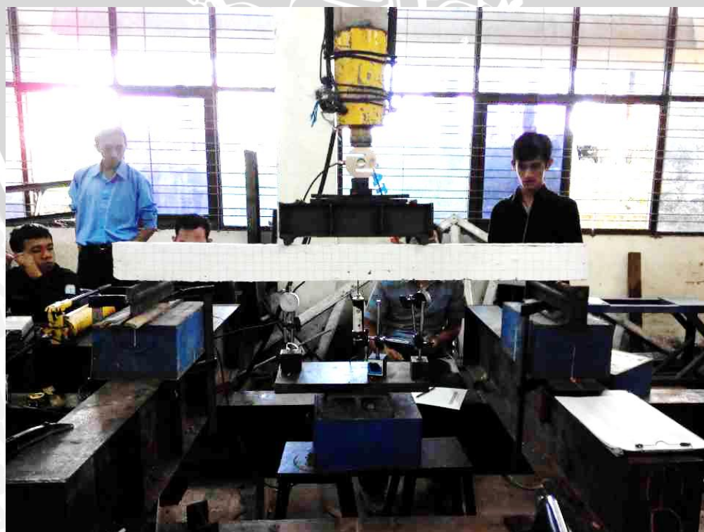
Gambar Pengujian Lentur Balok
