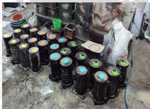
Gambar Cetakan Silinder 150 x 300 mm
