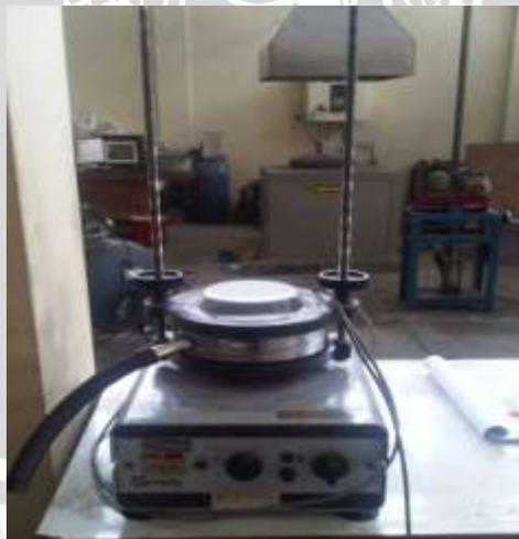
Gambar 3.1 Mesin Pengguncang Rotap
