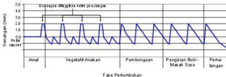
Gambar 2.8 Skema Pemberian Air Metode SRI
