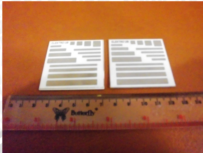
Gambar 4.16 Hasil Konduktor pada Substrat 5 dan 6 Hasil Cetakan Screen T165 dengan Proses Firing 600°C dan 700°C
