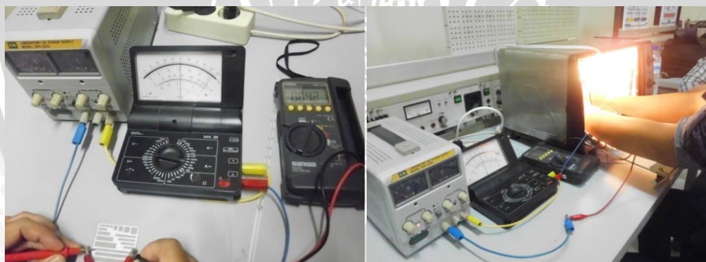
Gambar 5.9 Proses Pengukuran Tegangan Konduktor Pada Suhu 27^{\circ}\text{C} dan Suhu 65^{\circ}\text{C} .
