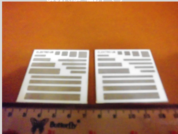
Gambar 4.17 Hasil Konduktor pada Substrat 7 dan 8 Hasil Cetakan Screen T150 dengan Proses Firing 600°C dan 700°C
