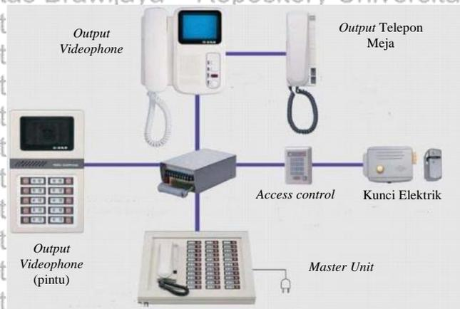
Gambar 2.92 Sistem Komunikasi pada Bangunan Kenegaraan
