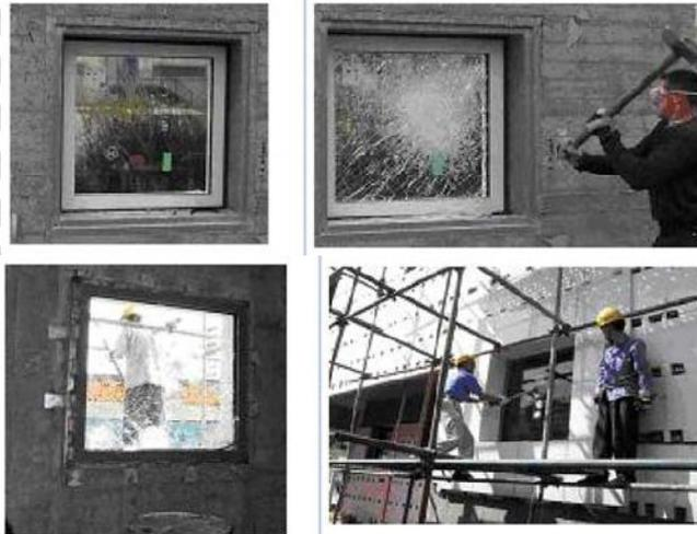
Gambar 2.81 Percobaan Penyusupan Selama 15 Menit
