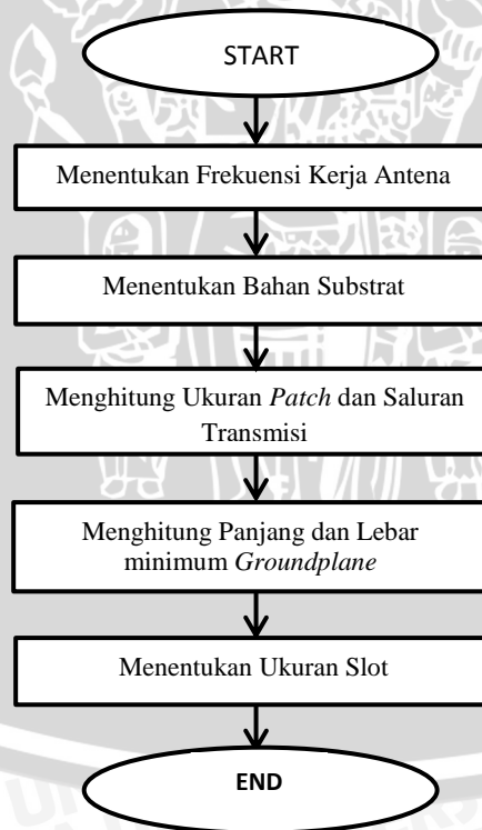
Gambar 3.2. Diagram Alir Perhitungan Dimensi Antena Mikrostrip
