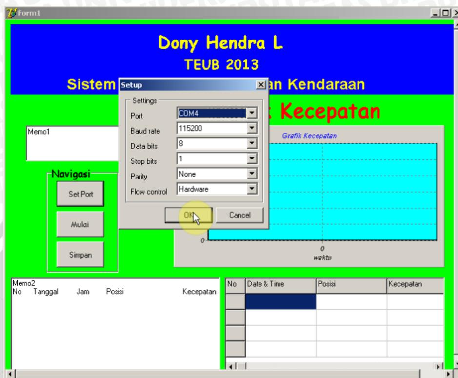
Gambar 5.24: Pengaturan Komunikasi Serial antara PC dengan Modem
