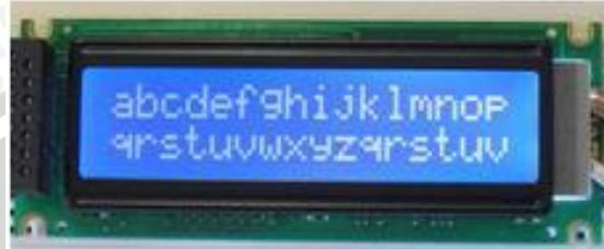
Gambar 2.10 Bentuk Fisik Modul LCD 16x2 Karakter
