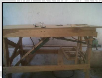
Gambar 4. 6 Circle, alat pemotong kayu yang menggunakan mesin
