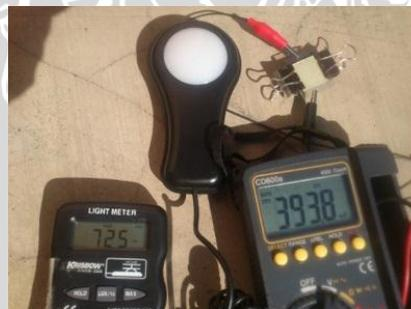
Gambar 5.4 Salah Satu Proses Pengujian  $V_{oc}$  DSSC Berbahan *Dye* Daun Pepaya
