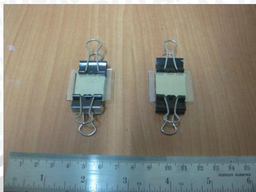
Gambar 4.14 Hasil Akhir Rancangan DSSC Berbasis Dye Dari Bahan Hasil Ekstraksi Daun Pepaya dan DSSC Berbasis Dye Dari Bahan Hasil Ekstraksi Daun Jarak Pagar
