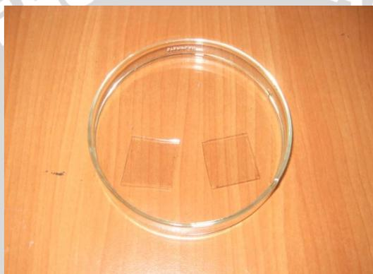
Gambar 4.5 Substrat TCO-ITO yang Telah Dipotong Menjadi  $6,25 \text{ cm}^2$
