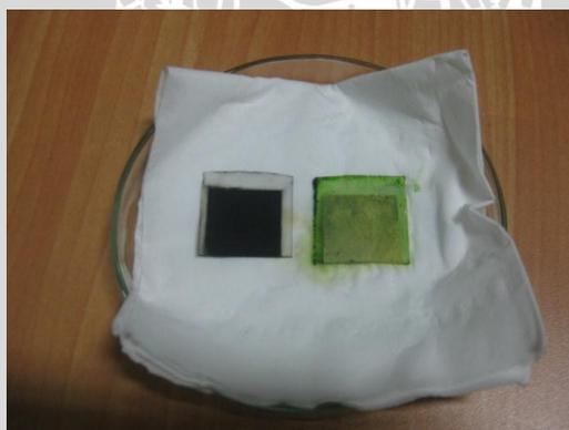
Gambar 4.13 Substrat Katoda dan Substrat Anoda Sebelum disatukan
