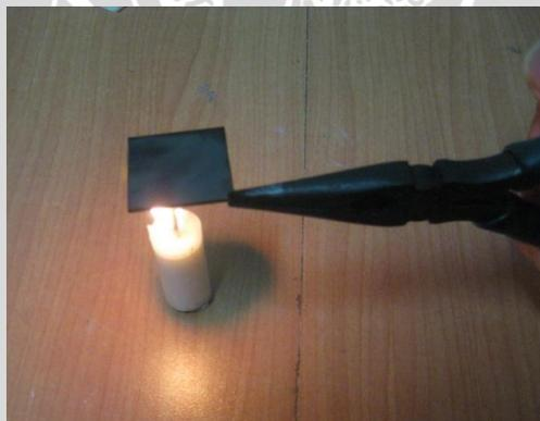
Gambar 4.7 Substrat Terlapisi Karbon Setelah Dibakar Permukaannya
