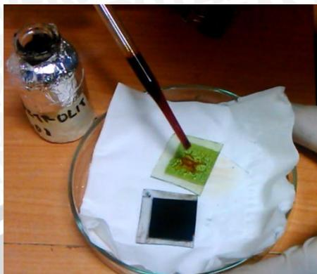
Gambar 4.12 Penetesan Elektrolit pada Substrat Anoda
