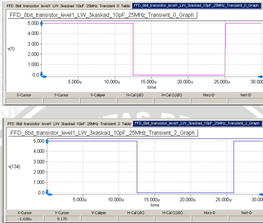
Gambar 5.6 Grafik unit step C=10pF, f=25MHz, V(1) Menunjukkan Input (atas) dan V(134) Menunjukkan Output (bawah).
