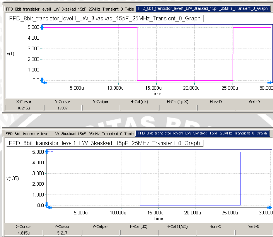
Gambar 5.16 Grafik unit step C=15\text{pF} , f=25\text{MHz} , V(1) Menunjukkan Input (atas) dan V(135) Menunjukkan Output (bawah).
