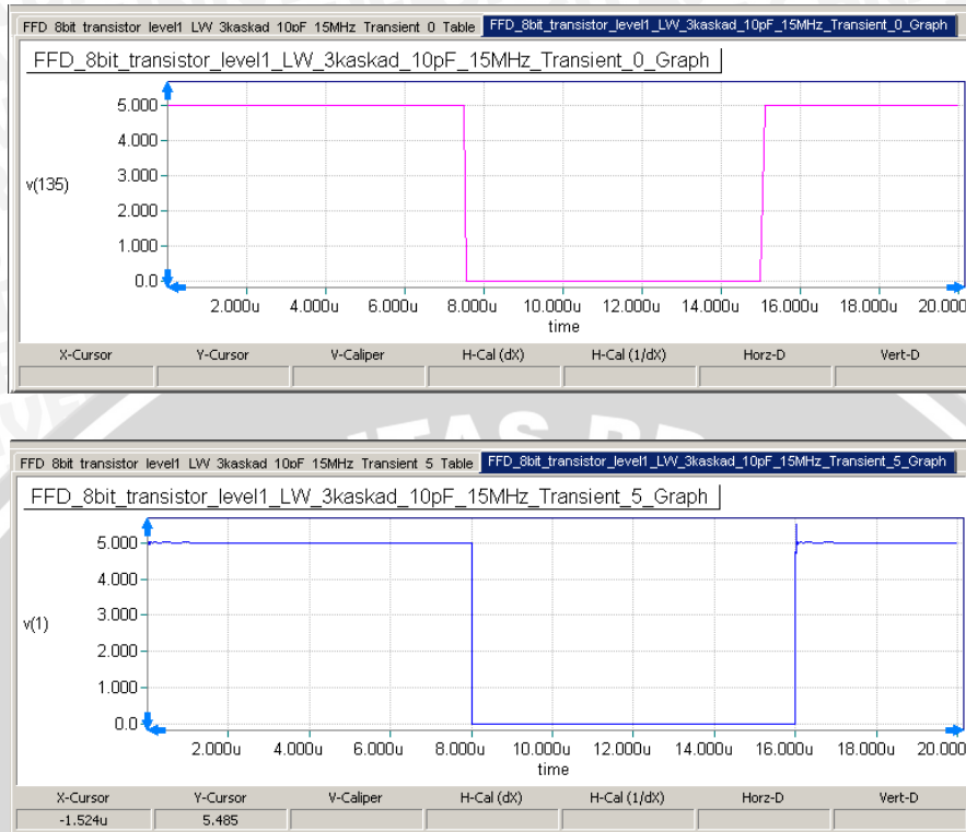
Gambar 5.4 Grafik unit step C=10pF, f=15MHz, V(1) Menunjukkan Input (atas) dan V(135) Menunjukkan Output (bawah).
