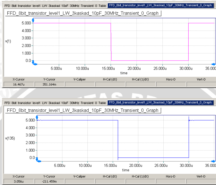
Gambar 5.7 Grafik unit step C=10\text{pF} , f=30\text{MHz} , V(1) Menunjukkan Input (atas) dan V(135) Menunjukkan Output (bawah).
