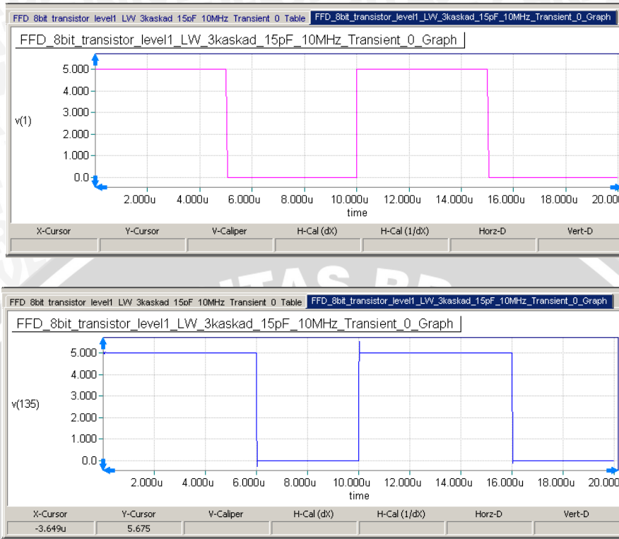
Gambar 5.13 Grafik unit step C=15pF , f=10MHz , V(1) Menunjukkan Input (atas) dan V(135) Menunjukkan Output (bawah).
