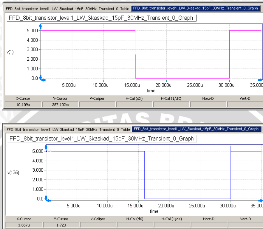
Gambar 5.17 Grafik unit step C=15pF, f=30MHz, V(1) Menunjukkan Input (atas) dan V(135) Menunjukkan Output (bawah).
