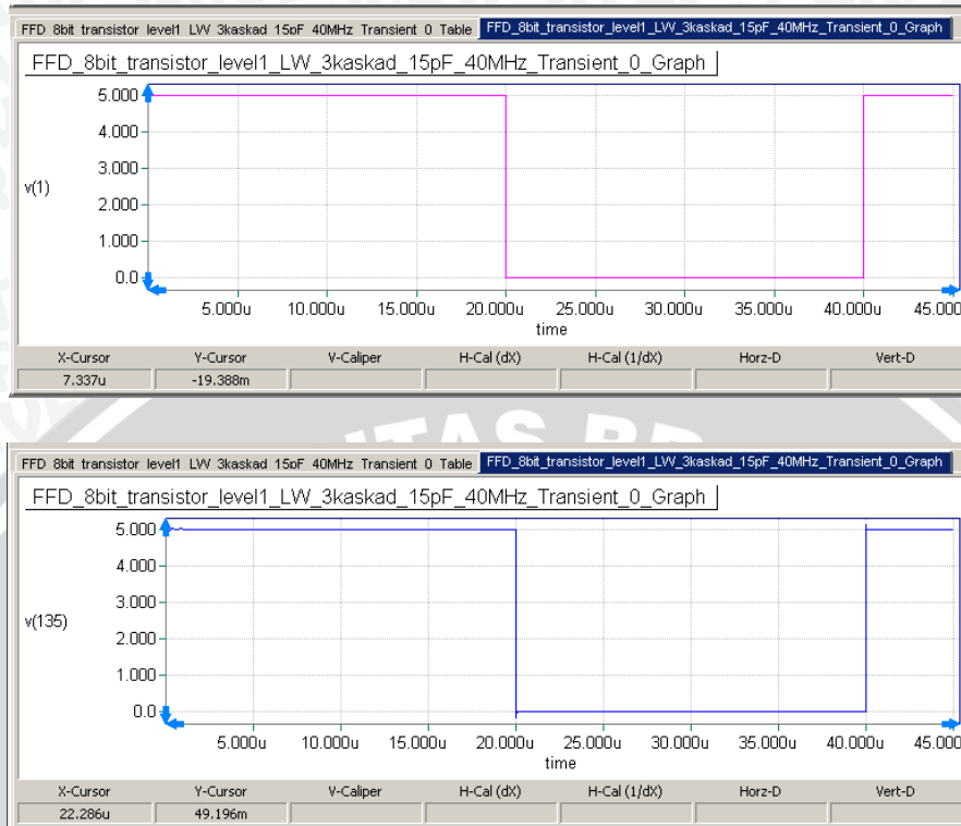
Gambar 5.19 Grafik unit step C=15\text{pF} , f=40\text{MHz} , V(1) Menunjukkan Input (atas) dan V(135) Menunjukkan Output (bawah).
