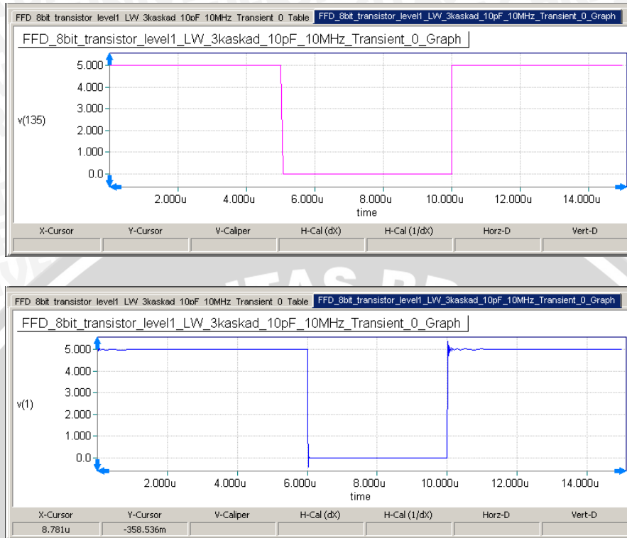
Gambar 5.3 Grafik unit step C=10\text{pF} , f=10\text{MHz} , V(1) Menunjukkan Input (bawah) dan V(135) Menunjukkan Output (atas).
