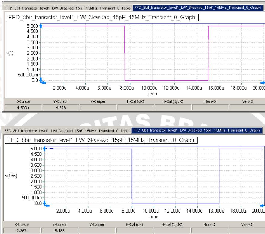
Gambar 5.14 Grafik unit step C=15\text{pF} , f=15\text{MHz} , V(1) Menunjukkan Input (atas) dan V(135) Menunjukkan Output (bawah).
