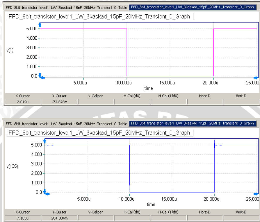
Gambar 5.15 Grafik unit step C=15pF, f=20MHz, V(1) Menunjukkan Input (atas) dan V(135) Menunjukkan Output (bawah).
