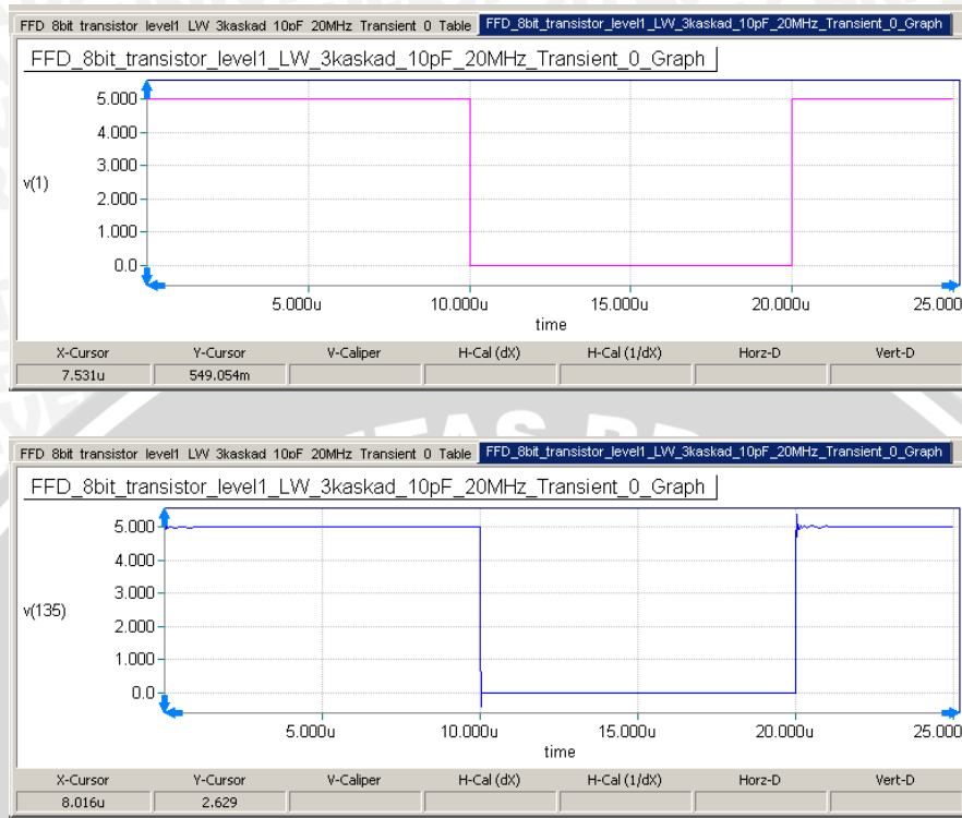
Gambar 5.5 Grafik unit step C=10\text{pF} , f=20\text{MHz} , V(1) Menunjukkan Input (atas) dan V(135) Menunjukkan Output (bawah).
