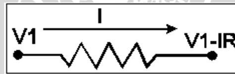
Gambar 2.2 Arus yang Mengalir Melewati Resistor yang Mempunyai Jatuh Tegangan
