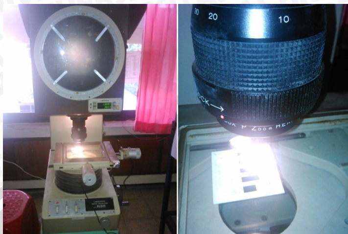
Gambar 5.1 Proses Pengukuran Penyimpangan Dimensi Menggunakan Profile Proyektor
