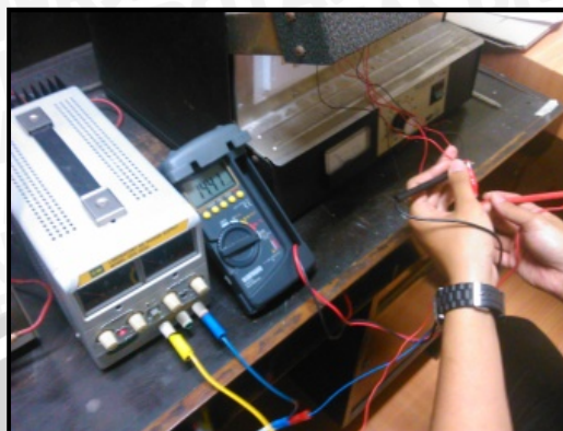
Gambar 5.8. Proses Pengukuran Tegangan Resistor pada Suhu Ruangan 150^{\circ}\text{C}
