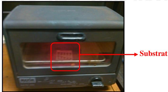
Gambar 4.14 Proses Pengeringan (*drying*)
