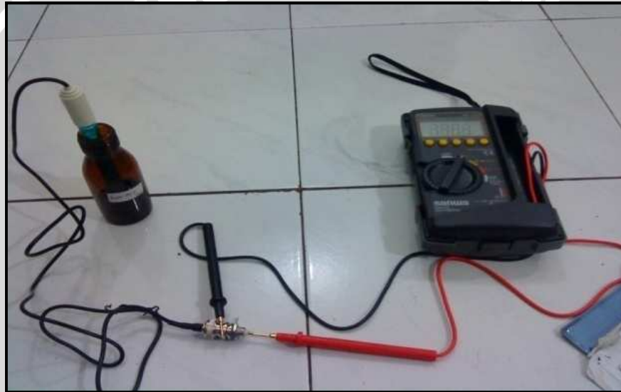
Gambar 5.7 Pengujian sensor pH pada larutan buffer
