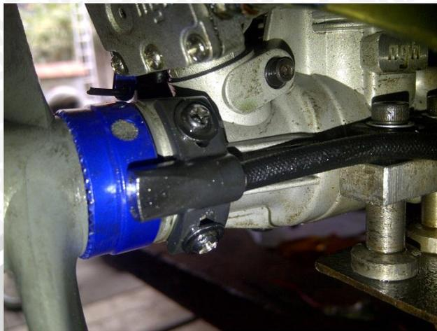
Gambar 4.3 Sensor Hall effect pada Gas Engine
