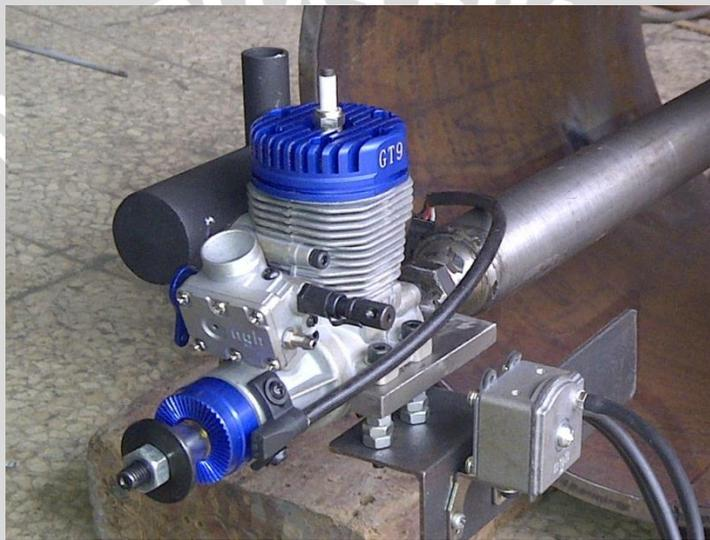
Gambar 4.2 Gas Engine 2-tak dengan displacement 9cc.
