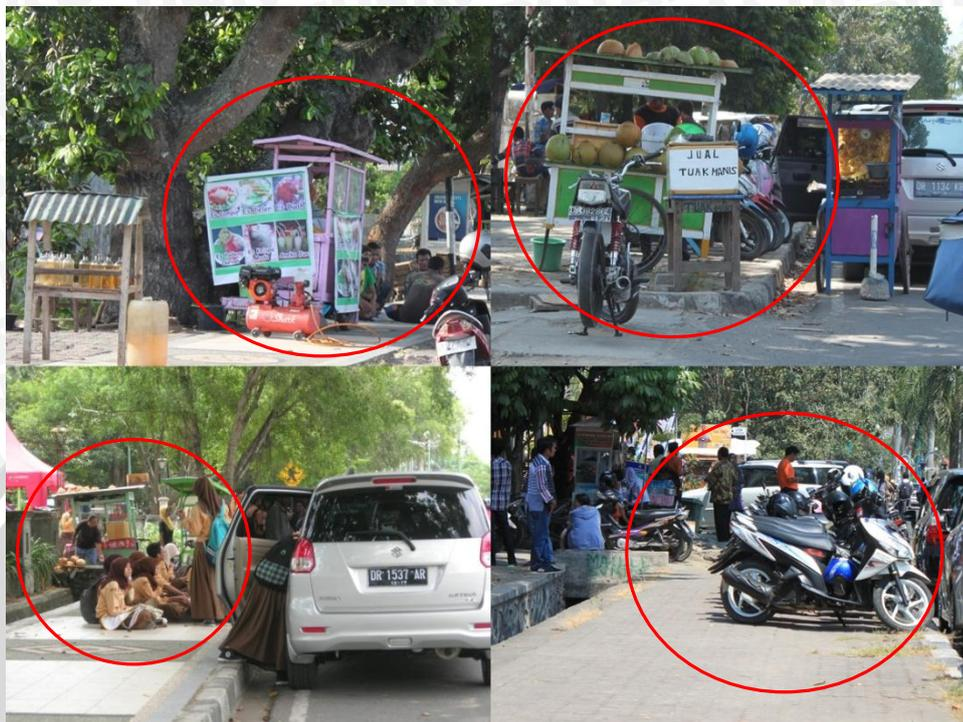
**Gambar 4. 14 Hambatan yang terdapat pada jalur pejalan kaki di koridor Jalan Udayana**
