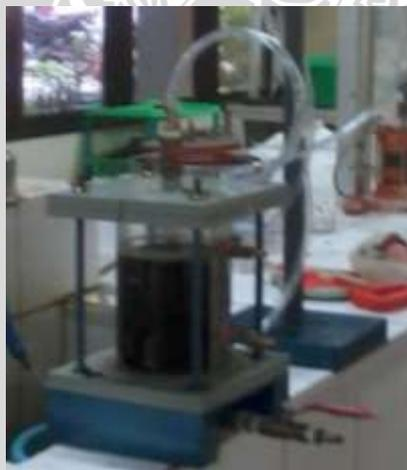
Gambar 3.18. Pengujian permeabilitas
