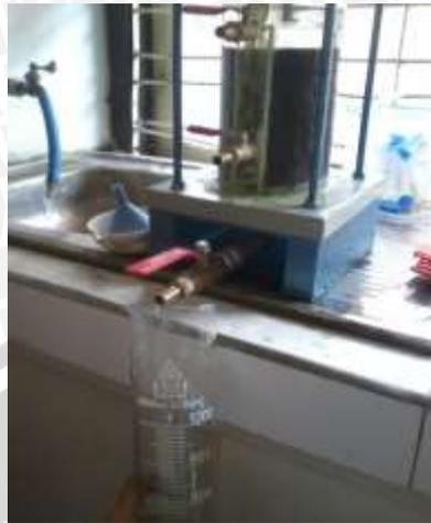
Gambar 3.19. Pengukuran permeabilitas
