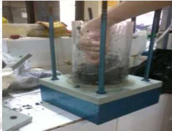
Gambar 3.10 Pemadatan ringan setiap ketinggian 2cm sampel tanah Sumber: Dokumentasi Penelitian
