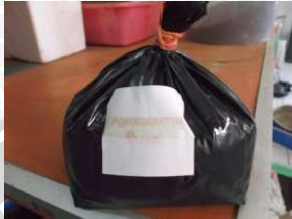
Gambar 3.9 Plastik polybag ditutup rapat dan didiamkan selama 30 hari Sumber: Dokumentasi Penelitian
