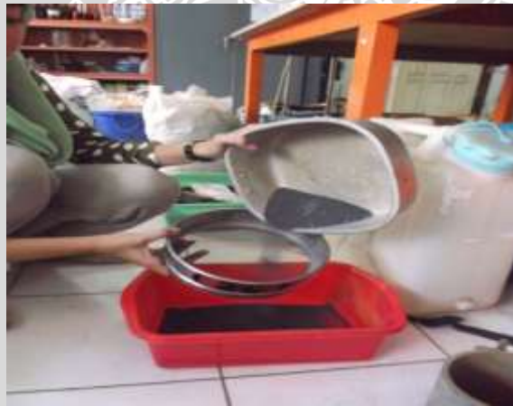
Gambar 3.6 Mengayak sampel tanah
