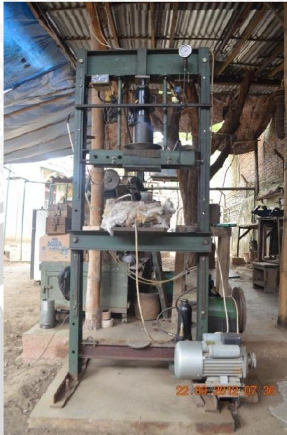
Gambar 3.5 Mesin kompaksi.
